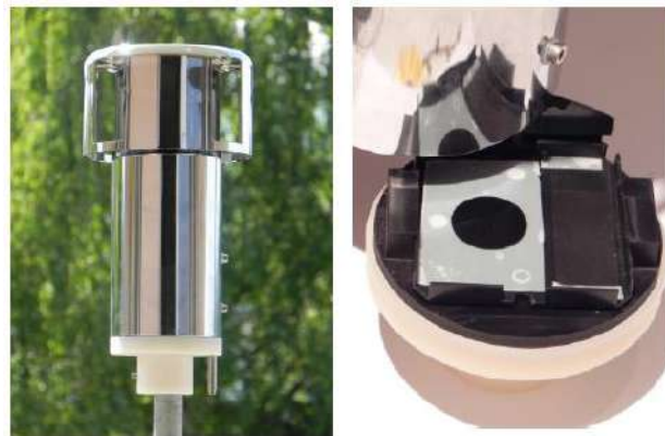
FIGURE 3 : ILLUSTRATION DU CAPTEUR PASSIF DE PARTICULES PM10
