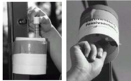
FIGURE 2 : ILLUSTRATION DE L'INSTALLATION DES TUBES PASSIFS - NO 2
